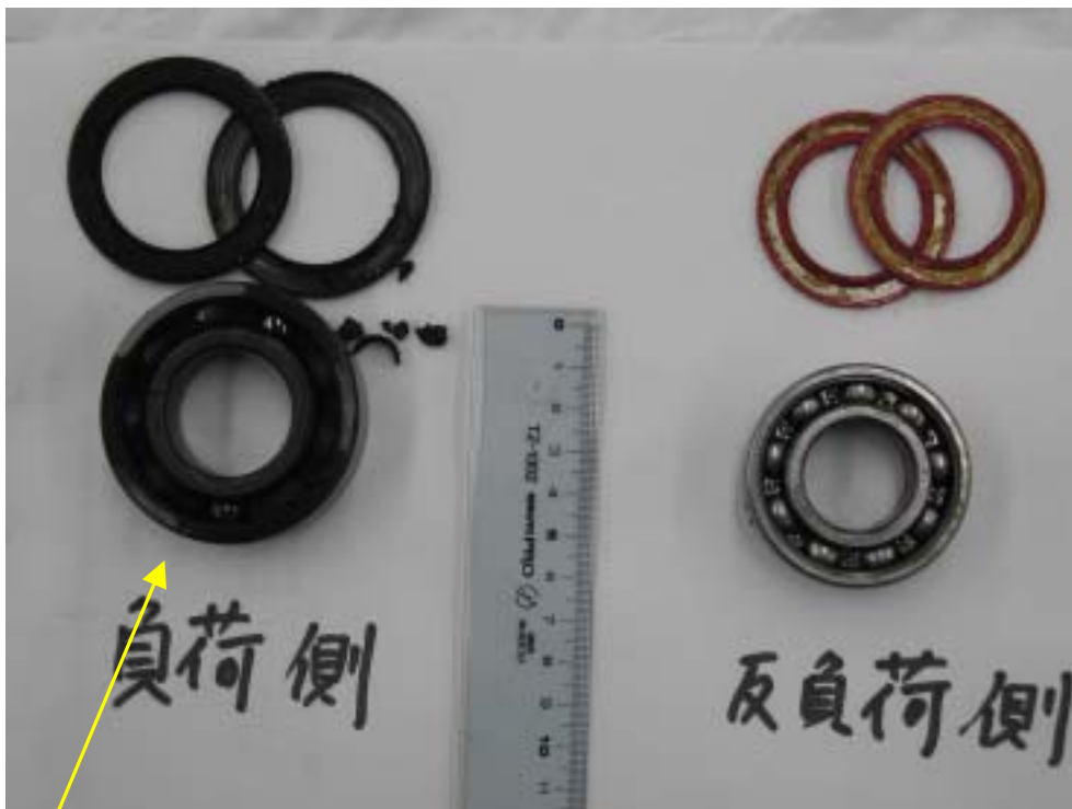
損傷部 (ファン側ベアリング)
