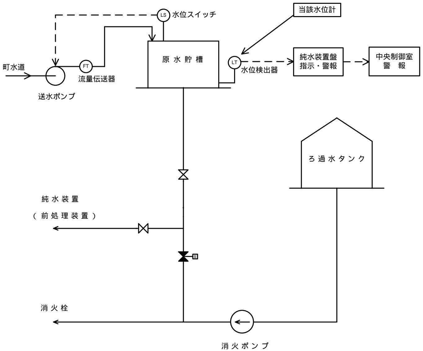
原水貯槽水位計概略図
