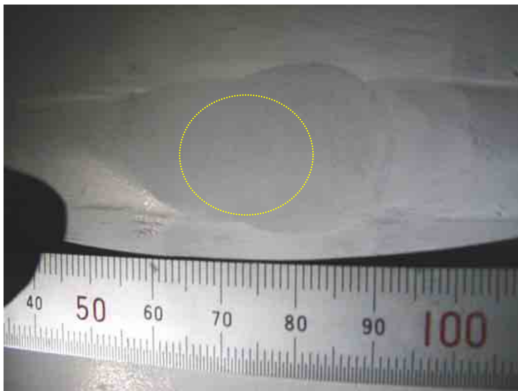
液体浸透探傷検査状況 表面を約1mm研磨後 指示なし
