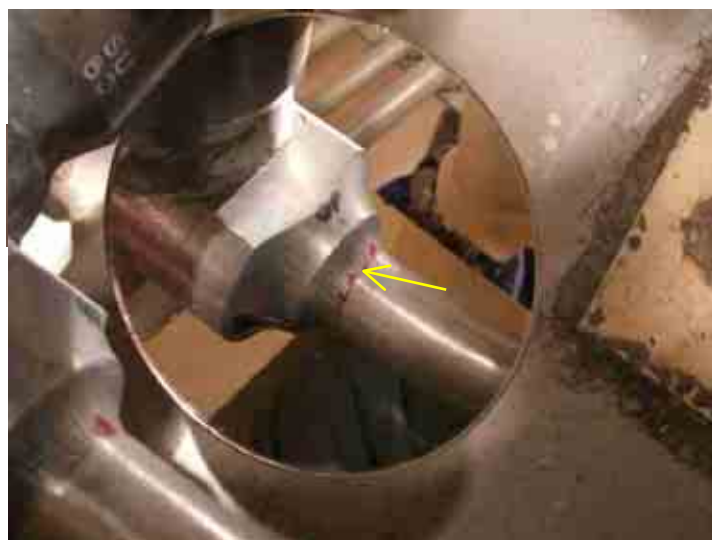
液体浸透探傷検査(PT)結果 (円周方向に約 28mm の指示)
