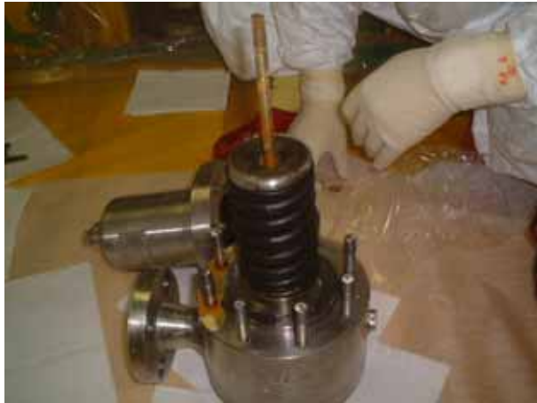
逃し弁分解状況(バネ部他)
