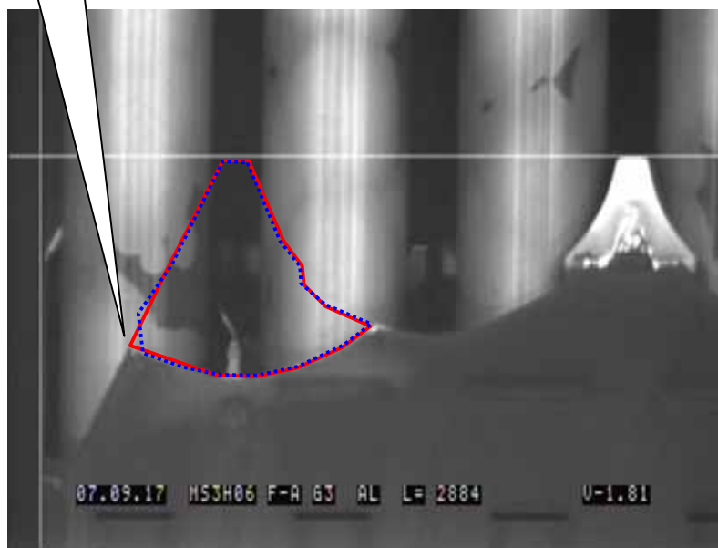
図2 第3支持格子ペーン欠損部
