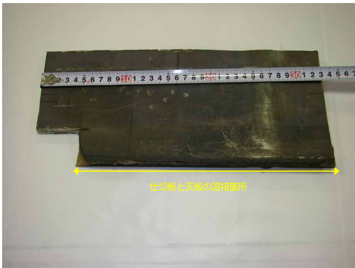
天板切り出し状況
