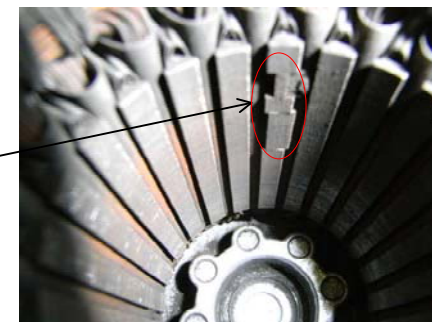
固定子の一部が変形
