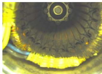
固定子内表面に金属粉が付着
