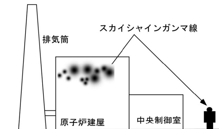
図7.15 原子炉冷却材喪失時の建屋内の放射性物質からのスカイシャインガンマ線による入退域時の被ばく (BWR型原子炉施設)
