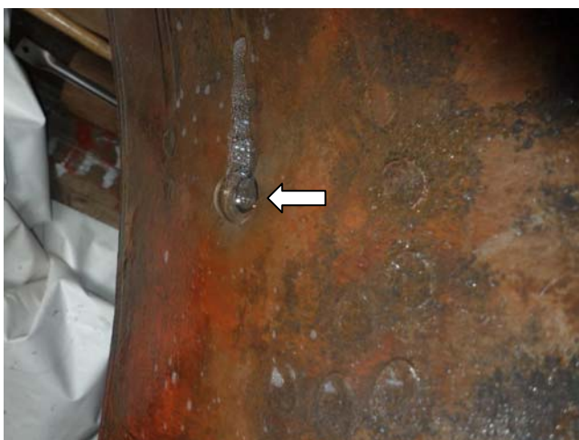
空気（気泡）による漏えい確認
