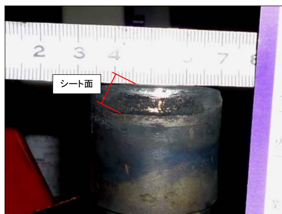
弁体 分解状態 (シート面にスケール付着)
