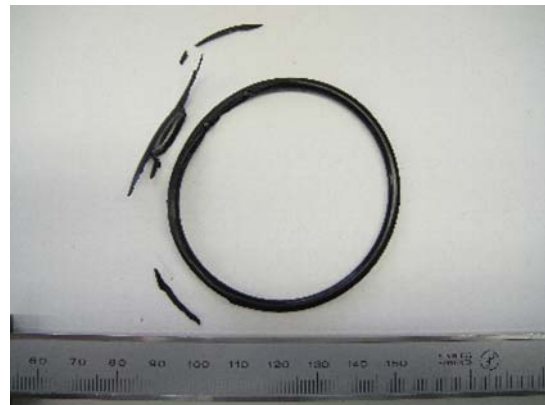
取り出したOリング 材質: ニトリルゴム 内径: 約55mm 太さ: 約3mm
