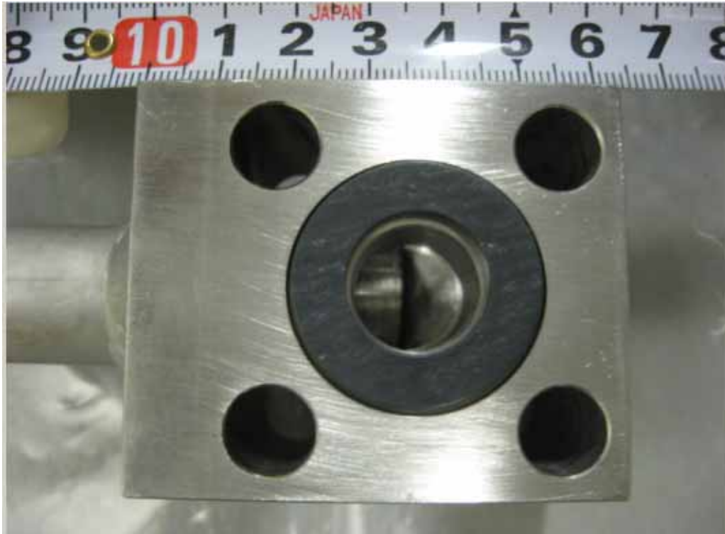
取り替え後のガスケット
