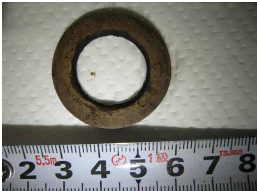
取り替え前のガスケット
