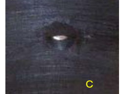
A, B, Cともに、 ・ライニングは局部的に剥離 ・炭素鋼管内面にほとんど減肉なし (腐食はほとんど発生していない) ・炭素鋼管内面に割れ等の異常はなし
