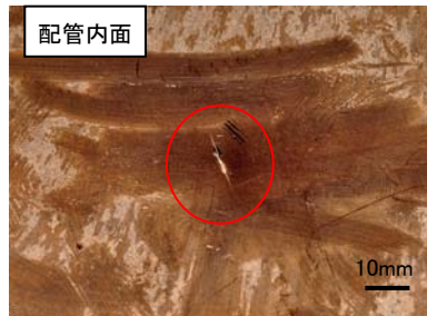
・錆こぶなし ・き裂は軸方向に約 10mm ・き裂部に外力が加わった跡なし
