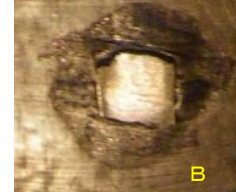
A・き裂は軸・周方向に約 20mm×3 B・き裂は軸方向に約 20mm C・き裂は周方向に約 10mm A, B, Cともに、 ・錆こぶなし ・き裂部に外力が加わった跡なし
