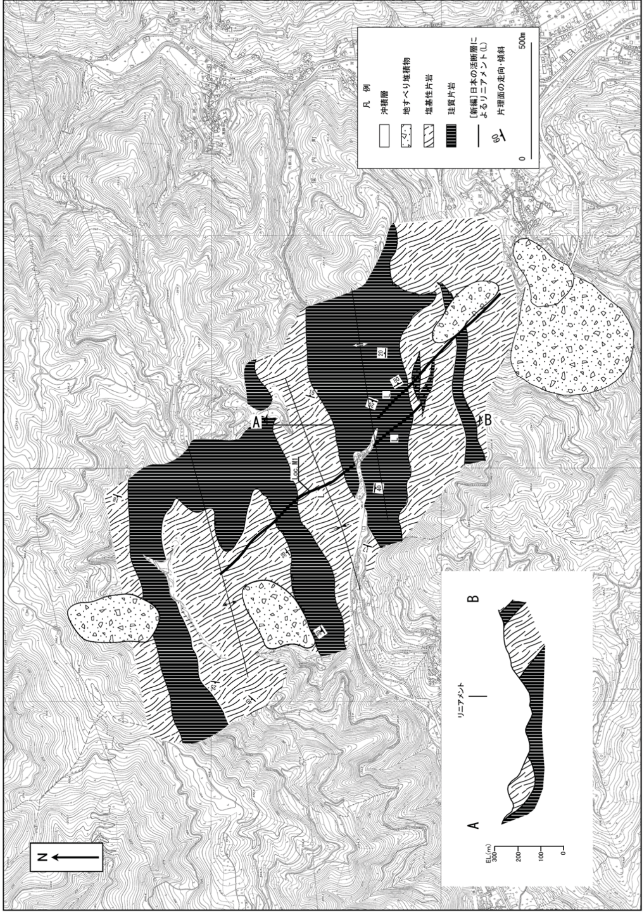
添付図-1.2：宮内リニアメント周辺の地質図・地質断面図（国土地理院発行5千分の1国土基本図を使用）
