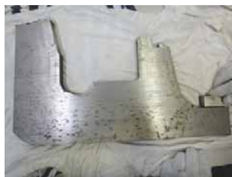
図2 軸受下部断面写真
