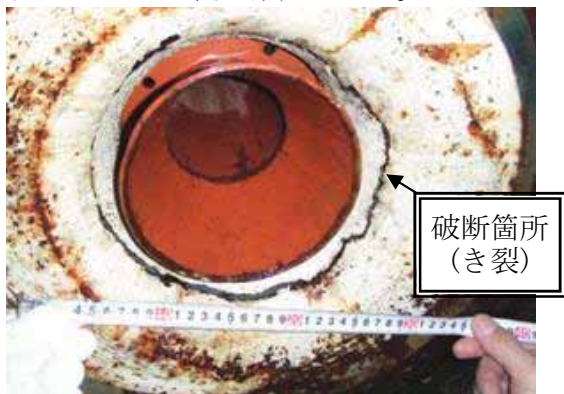
②軸受下部円筒根元部外側（B視） 全周にわたりき裂が確認された。
