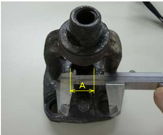
弁フタ (グランドパッキン挿入部)
