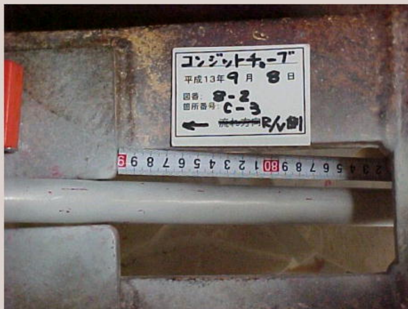
案内管液体浸透探傷検査結果（C－3）
