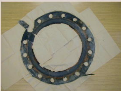
漏えいしたパッキン
