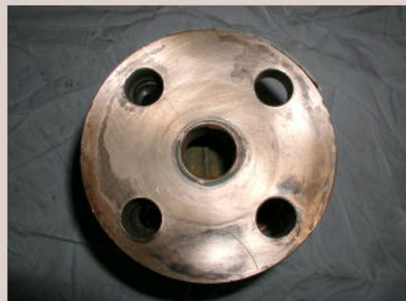
逆止弁手入れ後 (下流側から撮影)
