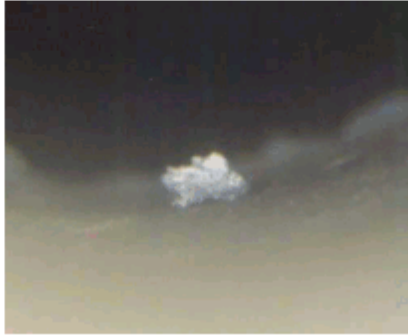
ノズル吹き出し口 付着物の大きさ: 100~200 \mu\text{m}
