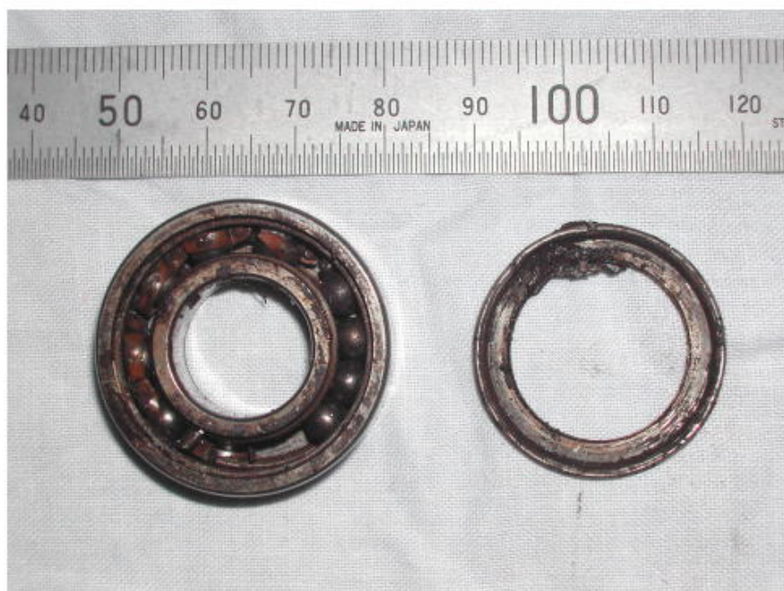
整流器冷却ファンの軸受（ボールベアリング）
