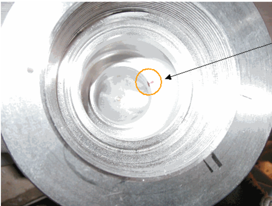
逆止弁弁座部 (液体浸透探傷検査実施状況)
