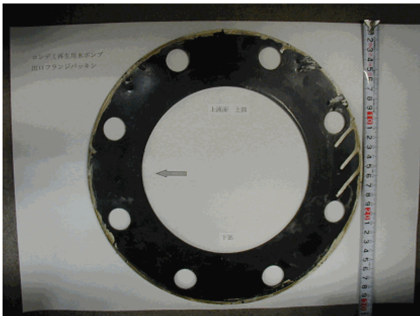
フランジパッキン 材質：合成ゴム 外径：280mm 内径：167mm 厚さ：3mm
