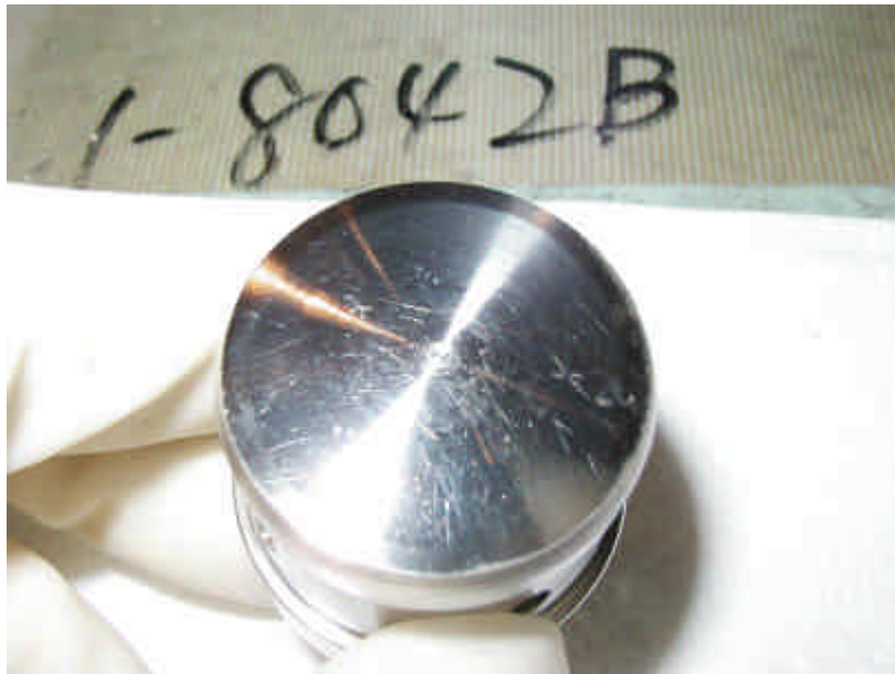
加圧器安全弁ウォーターシールドレン弁弁体写真
