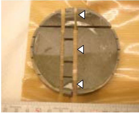
[ 軸端側破面 ] 測定方向
