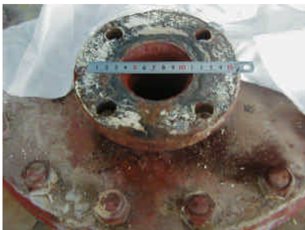
フランジ部 上段：ポンプ側 下段：本体側
