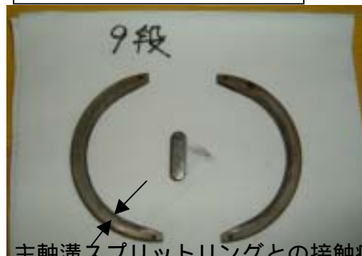
主軸溝スプリットリングとの接触痕
