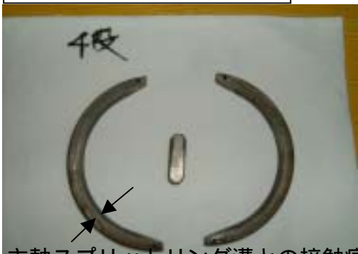
主軸スプリットリング溝との接触痕
