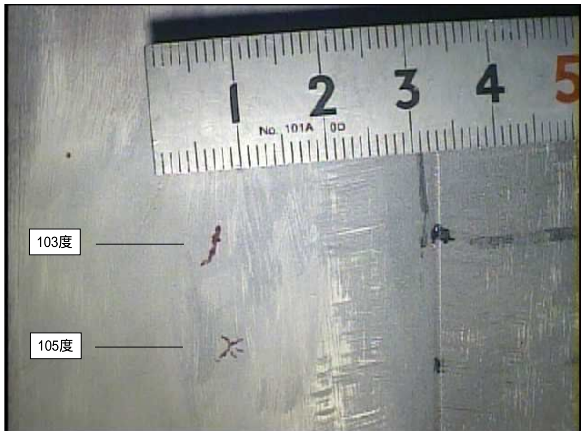
原子炉容器入口管台 (#B) 内面PT結果
