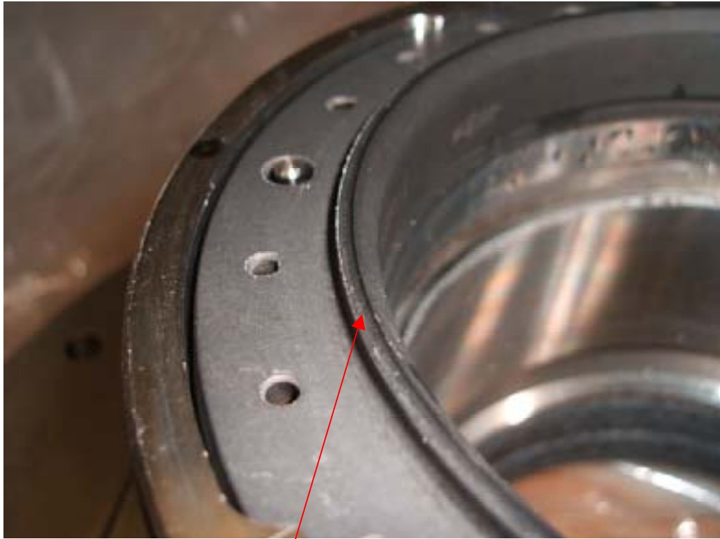
遊動環が正規の取付方向とは逆であった。
