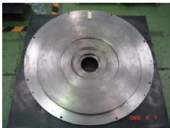
吐出側仕切板
