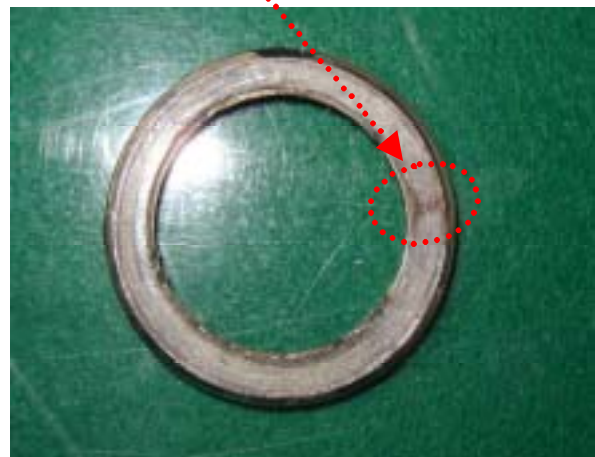
ガスケット写真(弁箱側より) ガスケット寸法: 41mm × 31mm × 3.2t
