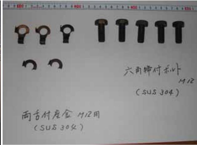
脱落していたボルト及び座金(当初回収分)
