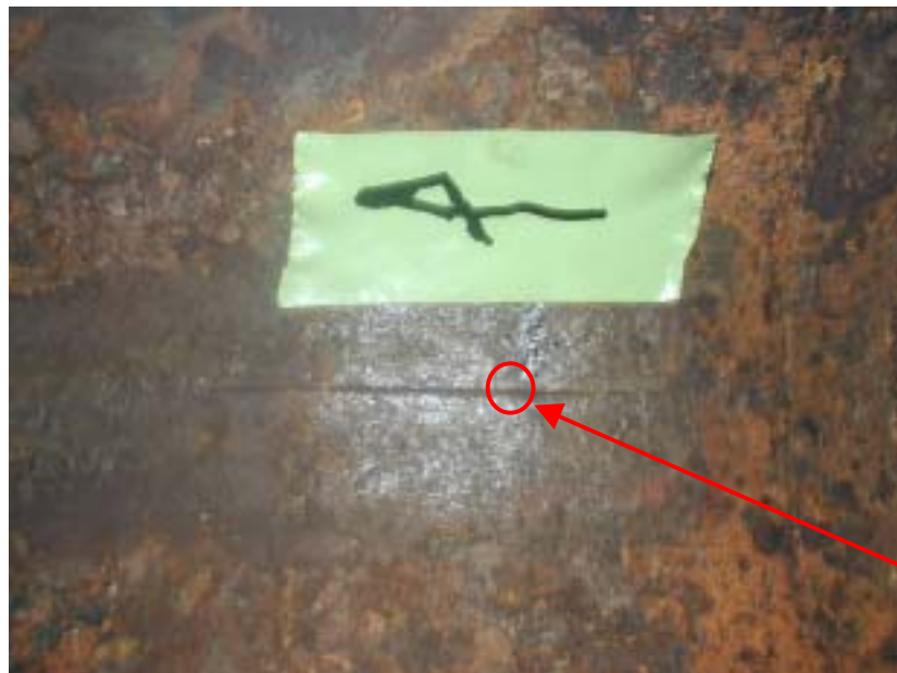
配管内面の貫通部周辺状況 (一部手入れ後)
