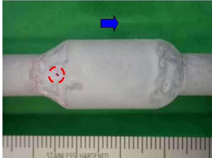
配管下部の外面
