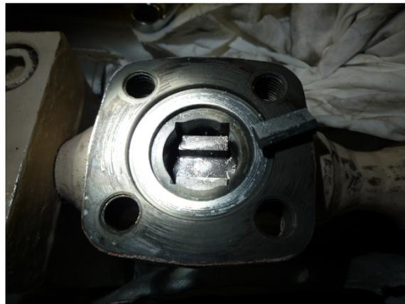
弁箱の様子（弁体が割れ、弁箱に残っている。）
