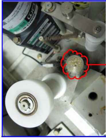
ろ紙駆動ローラ軸折損部
