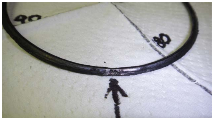
Oリング (材質:エチレン・プロピレンゴム)
