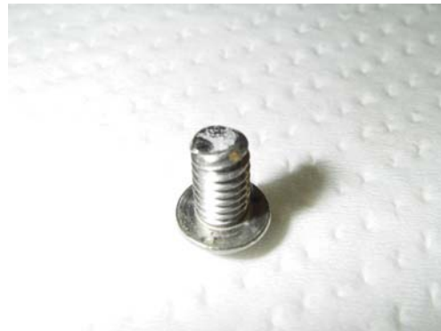
折損した取り付けボルト
