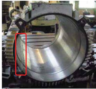
溶接補修箇所
