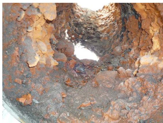
タービン建家非常用排水ポンプ出口排水配管内面状況（錆除去後）
