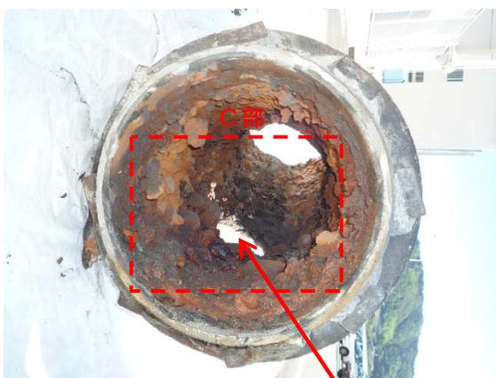
C部（下流側曲げ管内部拡大）
