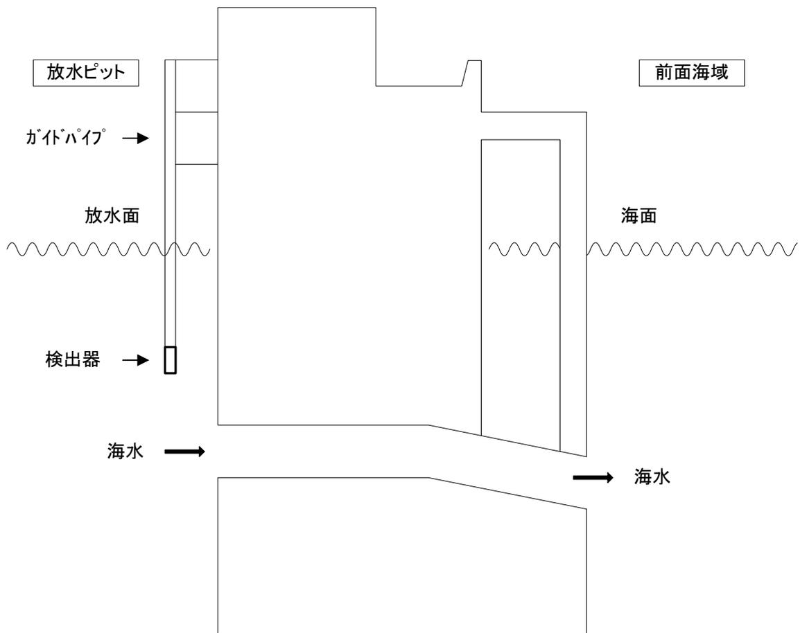
3号機放水ピット水モニタ設置図
