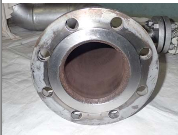
出口配管のフランジ面 (炭素鋼製、平面座フランジ)
