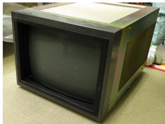
CRTユニット (取り出した状態)
