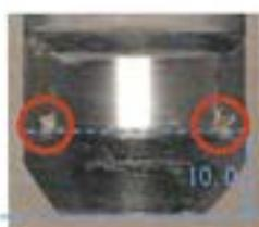
図4 接手外面円筒部の局所的接触痕
