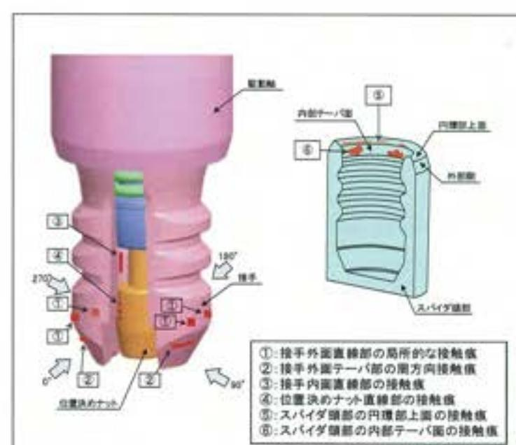
図-2:駆動軸およびスパイダ頭部の外観確認結果
