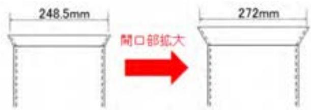
図3-6 点検装置ラックの開口寸法拡大
