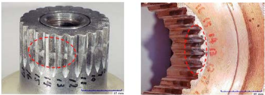
図8 放電試験後 解体品の確認結果
