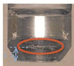
図 2 接手外面テーパ部の接触痕
