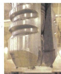
図２ M-4 駆動軸接手部に確認された付着物 (1月25日)
