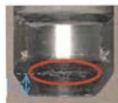
図２ 接手外面テーパ部の接触痕
