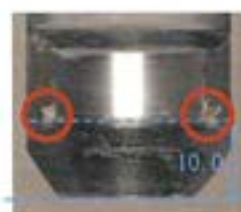
図４ 接手外面円筒部の局所的接触痕
