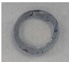
内面に周方向の傷が認められた。インペラユニットのマグネットキャン外面との擦れによるものと考えられる。リアスラストおよびリアスラスト挿入部に摩耗が認められた。
