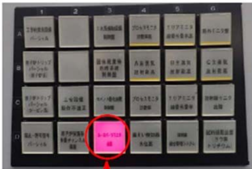
「ルースパーツモニタ装置」点灯
